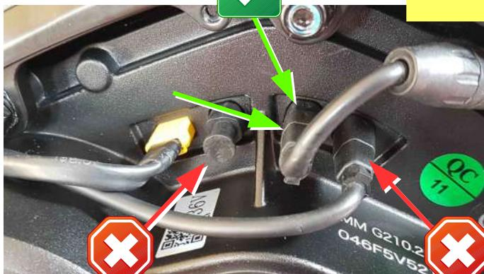
Individuare il connettore del sensore di velocità.
