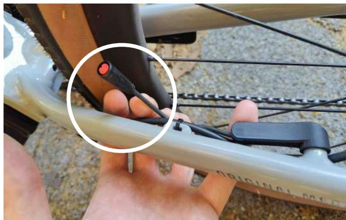
Individuare il connettore del sensore di velocità.
